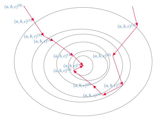
FIGURE 2 – Illustration de la descente de gradient vers la solution optimale  $(a, b, c)^{(\star)}$  de la fonction g que l'on souhaite minimiser en fonction des paramètres a, b et c Les différentes ellipses représentent des lignes de niveau de la fonction g.
